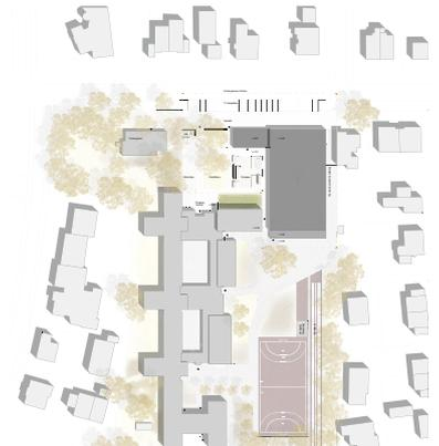
**Kontext** Unter Abwägung der vielschichtigen Anforderungen wird der Baukörper der Sporthalle bewusst in Längsausrichtung (N-S) auf die östliche Baugrenze positioniert und um ein Geschoss eingegraben. Die schmale Stirnseite der Halle präsentiert sich als prägnanter Baukörper zur Hildburghäuserstraße. Zusammen mit dem Eingangsgebäude bildet der Neubau das Entree und eine neue Einfassung für den Schulstandort „Am Karpfenteich“. Die Neubaumassnahmen verfolgen eine identitätsstiftende Wirkung.
